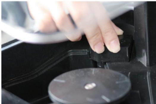
Der Vernebler ist der Ort, an dem flüssiger Alkohol aus dem Reservoir (Tank) in ein feines Aerosol verwandelt wird. Diese Aerosol poliert Ihren Druck. Innerhalb der Patrone befindet sich eine mikrobearbeitete Metallscheibe, die mit hoher Geschwindigkeit vibriert. Ein Schwamm-Docht leitet das flüssige Lösungsmittel auf die Scheibe.
