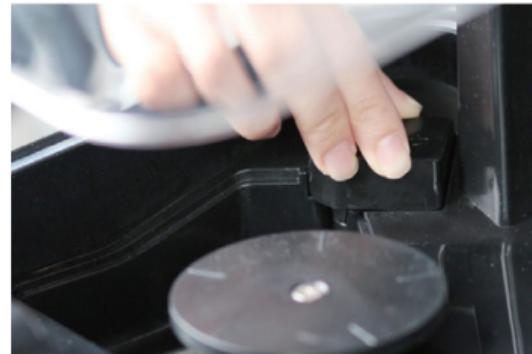
Le nébuliseur est l'endroit où l'alcool liquide provenant du réservoir est transformé en un aérosol fin qui polit votre pièce imprimée. L'intérieur du nébuliseur est un disque métallique micromécanisé qui vibre des centaines de milliers de fois par seconde. Une éponge spéciale permet au solvant liquide de constamment atteindre le disque.
