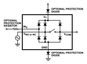
FIGURE 7. OVERVOLTAGE PROTECTION
