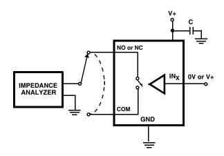
FIGURE 6. CAPACITANCE TEST CIRCUIT
