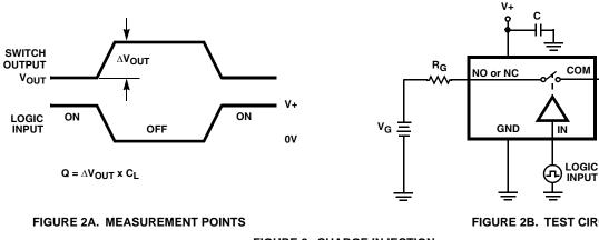
**FIGURE 2. CHARGE INJECTION**
