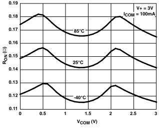
FIGURE 9. ON RESISTANCE vs SWITCH VOLTAGE
