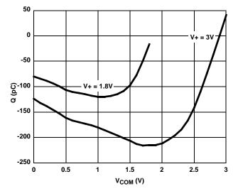
FIGURE 11. CHARGE INJECTION vs SWITCH VOLTAGE
