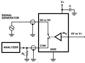
FIGURE 3. OFF ISOLATION TEST CIRCUIT
