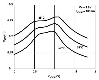
FIGURE 10. ON RESISTANCE vs SWITCH VOLTAGE
