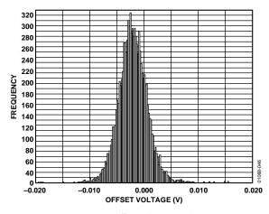
Figure 41. AD8109 Offset Voltage Distribution (RTI)
