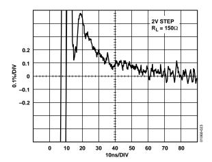
Figure 18. AD8109 Settling Time
