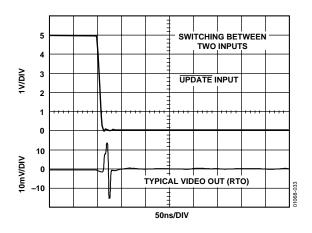
Figure 28. AD8109 Switching Transient (Glitch)
