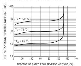
FIG.3 TYPICAL REVERSE CHARACTERISTICS
