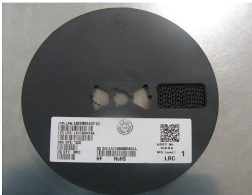
7英寸卷盘标签张贴及QA印章位置
