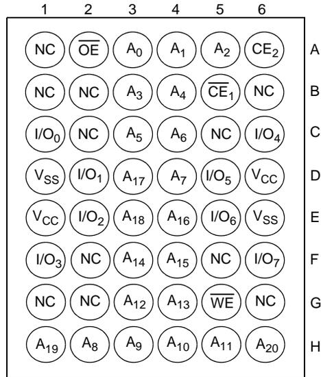
图 4. 48 ball VFBGA 引脚分布 (顶视图) — CY7C1069GE [4、5]
