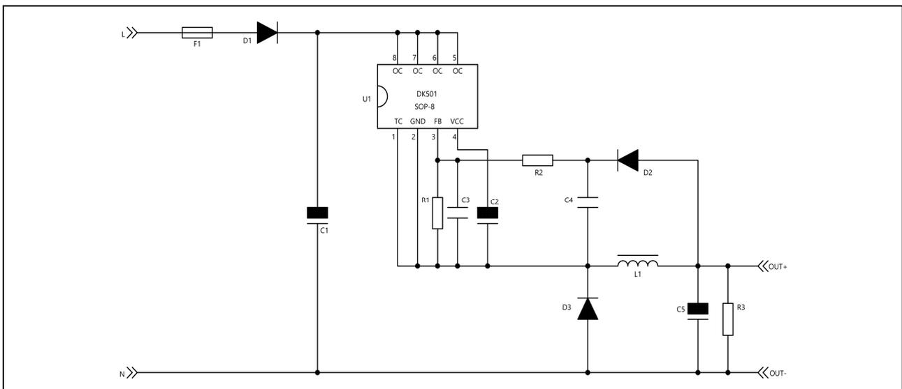
参考典型应用图，输出电压可通过 FB 分压电路调节，实际应用中由于 FB 对输出的电压采样受到隔离二极管影响，需要微调。近似公式如下：
