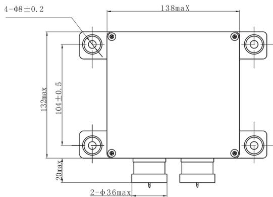
图a. 外形及安装尺寸图
