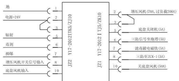
图b. 电气接口图
