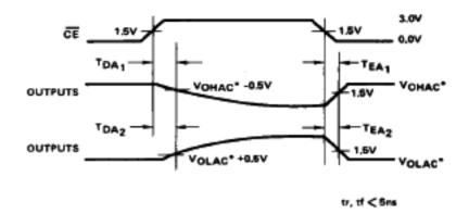
\*VOLAC AND VOHAC ARE THE MEASURED OUTPUT VOLTAGE LEVELS WHILE ENABLED.
