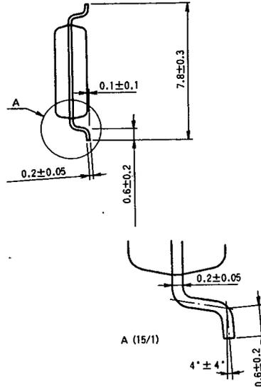
TYPE 16P2N 16PIN MOLDED PLASTIC SOP
