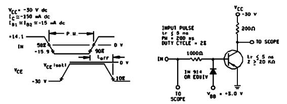
TURN-ON ( OFF) TIME TEST CIRCUIT
