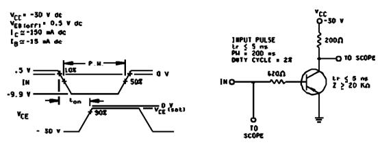
TURN-ON (ton) TIME TEST CIRCUIT
