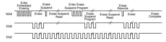
**Note:** The system may use OE# or CE# to toggle DQ2 and DQ6. DQ2 toggles only when read at an address within the erase-suspended sector.
