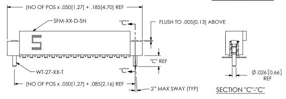
FIG 7 -SNX: SOLDER NAIL
