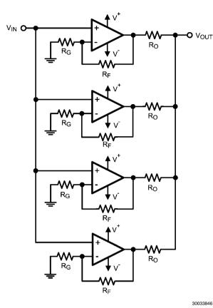
**FIGURE 2. Noise Reduction Circuit**
