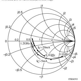
$$\begin{split} &\text{S12e:V}_{CE}\text{=-}10\text{V} \\ &\text{f=-}100\text{MHz}, 200 \text{ to } 1200\text{MHz} (200\text{MHz step}) \end{split}$$
