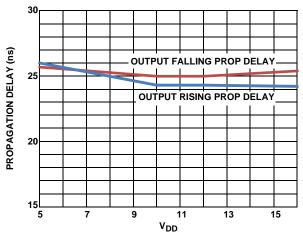
FIGURE 15. PROPAGATION DELAY vs  $V_{\mbox{\scriptsize DD}}$
