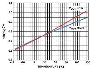
FIGURE 13. r<sub>DS(ON)</sub> vs TEMPERATURE
