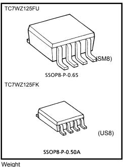
SSOP8-P-0.65 : 0.02 g (typ.) SSOP8-P-0.50A : 0.01 g (typ.)
