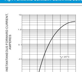
Fig.3-TYPICAL INSTANTANEOUS FORWARD CHARACTERISTICS
