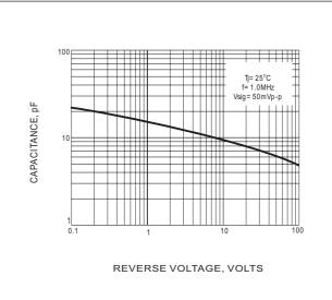
Fig.4 TYPICAL JUNCTION CAPACITANCE
