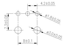
PCB LAYOUT COMPONENT SIDE
