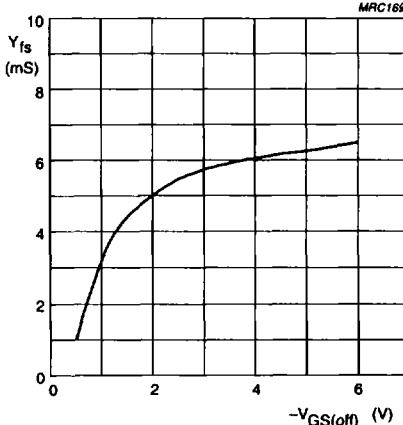
$V_{DS} = 15\text{ V}$ ;  $T_j = 25^\circ\text{C}$ ; typical values.
