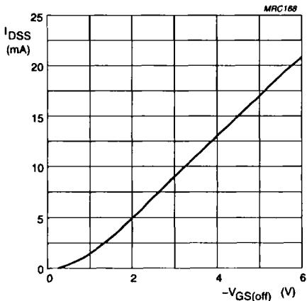
$V_{DS} = 15\text{ V}$ ;  $T_j = 25^\circ\text{C}$ ; typical values.
