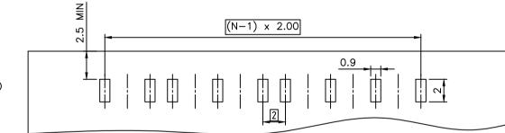
RECOMMENDED LAYOUT PAD SHOULD BE LOADED ACCORDING TO STYLE
