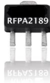
3 Pin SOT-89 Package
