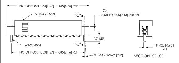
FIG 7 -SNX: SOLDER NAIL (SAME AS FIG 1, DIFFERENT AS SHOWN)
