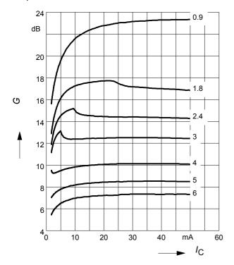
Power gain  $G_{ma}$ ,  $G_{ms} = f(V_{CE})$
