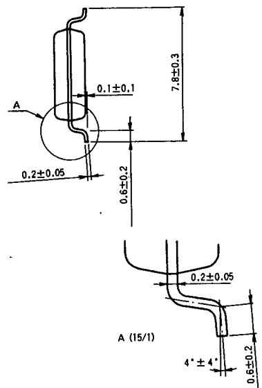
TYPE 16P2N 16PIN MOLDED PLASTIC SOP
