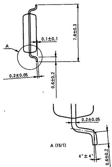
TYPE 16P2N 16PIN MOLDED PLASTIC SOP
