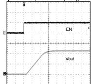
CH1: EN pin; Scale: 2V/Div CH2: V<sub>OUT</sub>; Scale: 2V/Div
