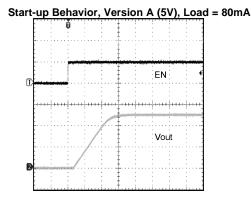
CH1: EN pin; Scale: 2V/Div CH2: V<sub>OUT</sub>; Scale: 2V/Div Time scale: 100µs/Div
