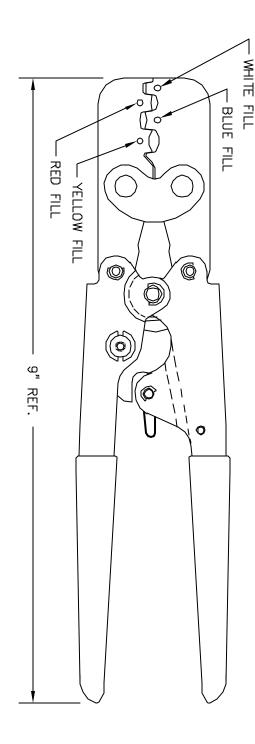
BLACK OXIDE FINISH JAW ASSEMBLY HEAT TREATED COMPONENTS
