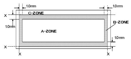
X: Maximum Seal Line. (図面によるシール許容基準線)
