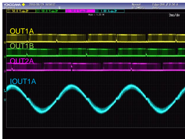
Figure 19. 1/16 STEP ( CLK : 9600Hz )
